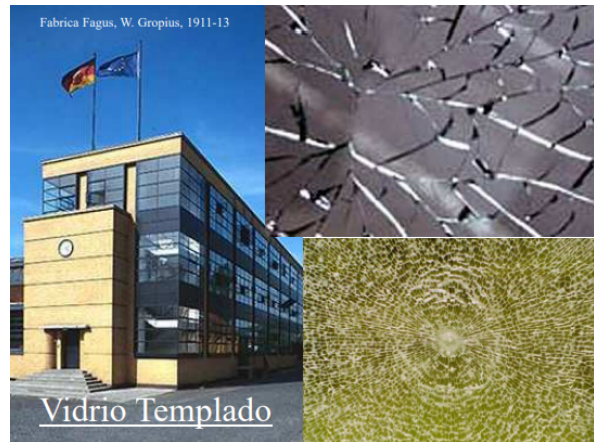
Imagen 34. Aplicación de Vidrio Templado
