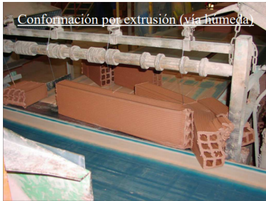
Imagen 7. Conformación por extrusión (vía húmeda)
