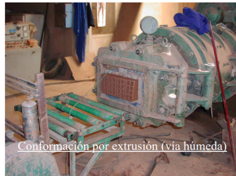
Imagen 6. Conformación por extrusión (vía húmeda)
