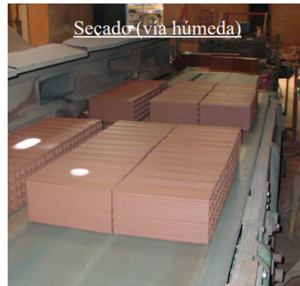
Imagen 8. Secado (vía húmeda)
