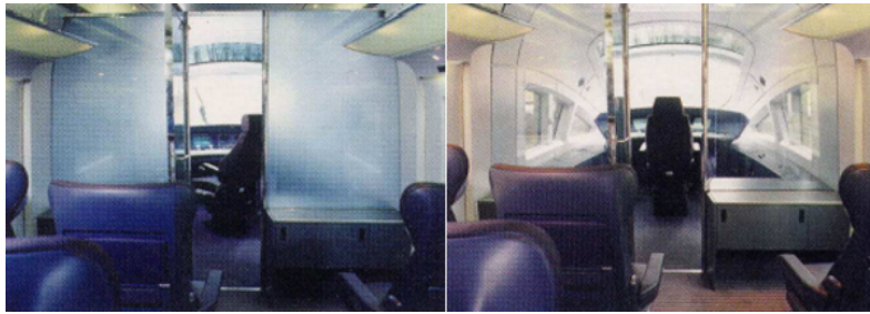
Imagen 42. Vidrio con capa termocrómica
