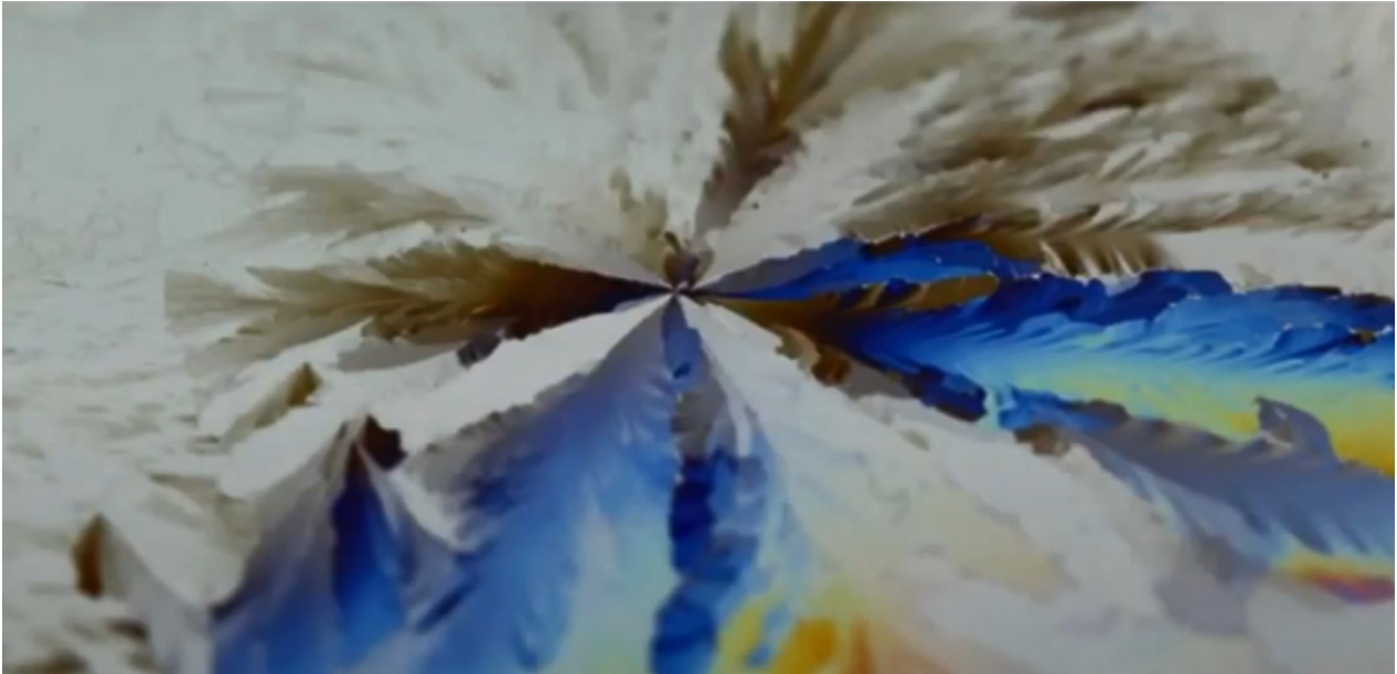
Figura 4. Colores de interferencia de un mineral birrefringente observada con luz polarizada cruzada.
