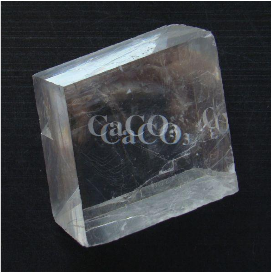
Figura 2. Cristal de calcita (espato de Islandia) empleado para demostrar su gran birrefringencia o doble refracción.
