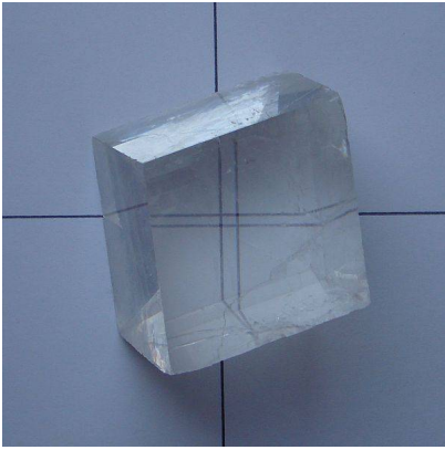
Figura 1. Cristal de calcita (espato de Islandia) empleado para demostrar su gran birrefringencia o doble refracción.
