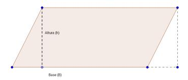
Al trazar la línea que nos da la altura (h), se crea un triángulo que, si lo transportamos al otro extremo del paralelogramo, completa el rectángulo, con lo que se puede usar la fórmula:
