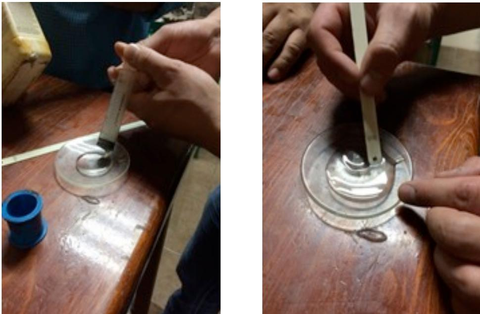
Figura 2.8. Materiales empleados para mezclar la resina y el catalizador.
